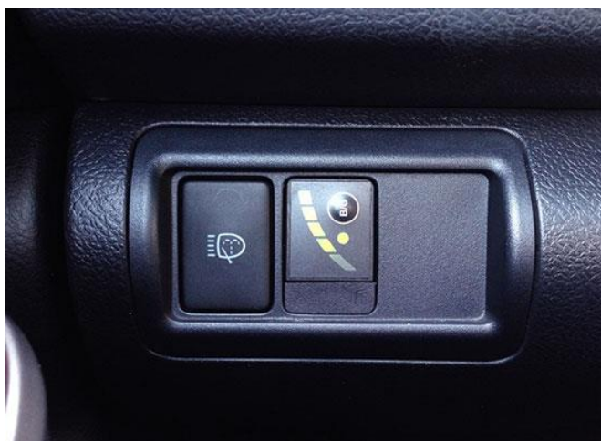
Сурет 1.25 - Автомобиль салонндағы аспап панеліндегі газ деңгейінің датчигі
