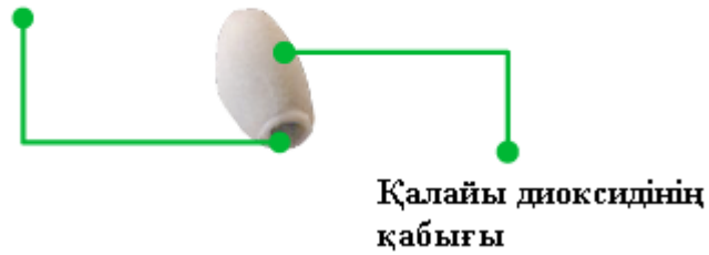
Сурет 2.5 – Сезгіш элемент - қалайы диоксидімен қапталған алюминий оксидіне негізделген керамика
